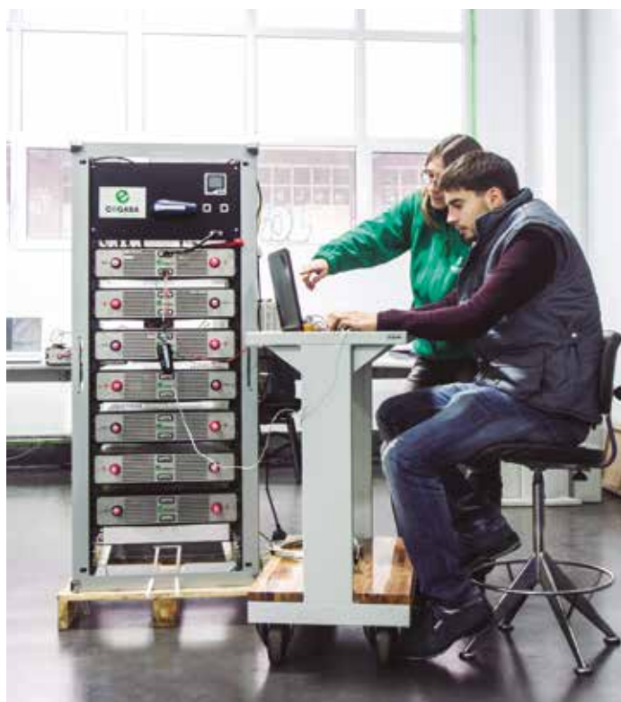
Batería de litio-ion modular enracable con módulos de 2,3 KWh.
