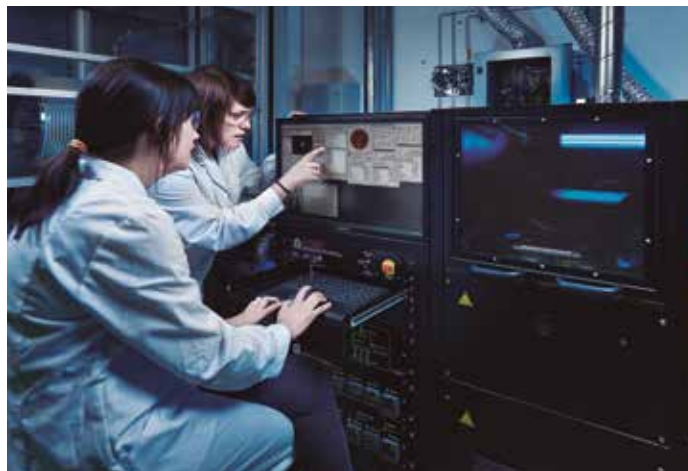
Reactor de 100mm para crecimiento de grafeno.
