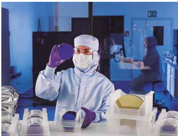
Sala blanca de Graphenea y grafeno monocapa sobre obleas de \text{SiO}_2/\text{Si} , al fondo reactores de crecimiento de grafeno.
