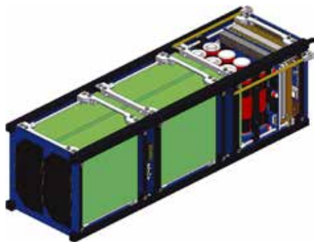
Figura 3. Representación de un nano-satélite 3U SpooQy-2, sin paneles solares desplegados, donde se puede ver en verde el volumen disponible para alojar dispositivos/experimentos (payload). En rojo las celdas convencionales de Li-ion que conforman el sistema de almacenamiento de energía junto al cual se disponen, en un reducido espacio, todos los sistemas de aviónica. Imagen tomada de la publicación EPJ Quantum Technology [12] .
