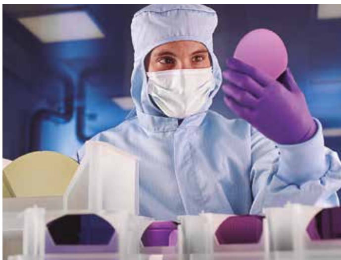
Sala blanca de Graphenea y grafeno monocapa sobre obleas de \text{SiO}_2/\text{Si} .
