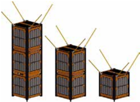
Figura 2. Representación isométrica de CubeSats 3U (izquierda), 2U (centro) y 1U (derecha) basados en la plataforma Gom-X de la empresa GomSpace. La unidad mínima, 1U, es un módulo de 10 cm de lado. Imagen tomada de la publicación EPJ Quantum Technology [12] .
