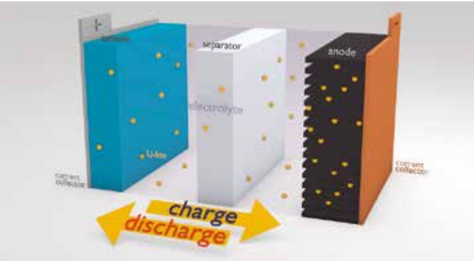
Figura 1. Esquema de una celda de Li-ion donde se muestran sus componentes fundamentales: ánodo, cátodo, electrolito, separador y colectores de corriente. Imagen elaborada por la empresa de baterías Leclanché [9] .
