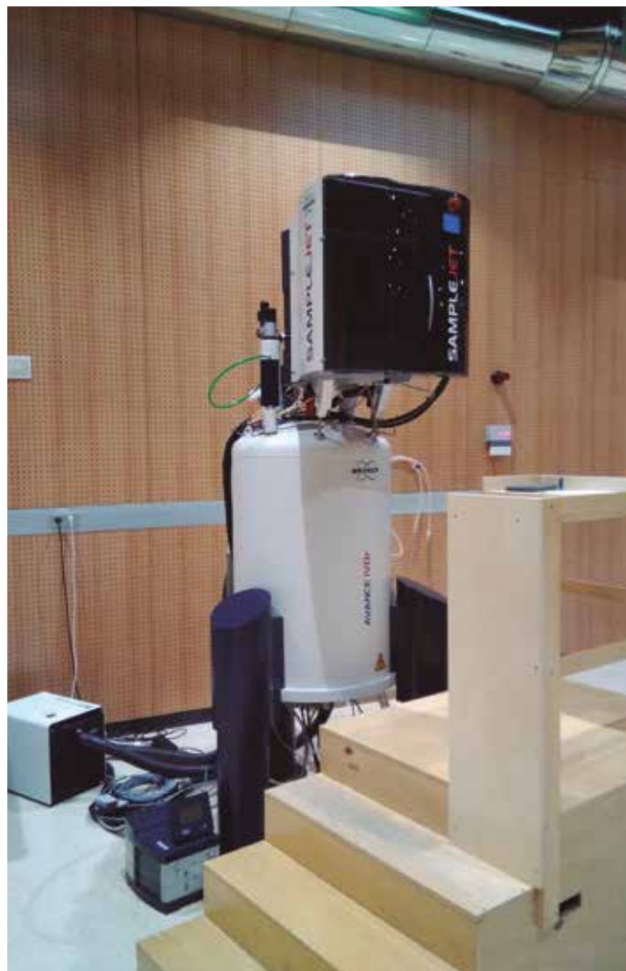
Figura 4. Espectrómetro IVDr de 600 MHz del CIC bioGUNE, dedicado al análisis metabolómico de muestras de suero y orina.
