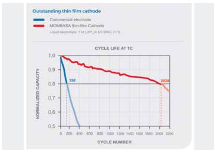
Figura 5. Comparativa de la ciclabilidad de los electrodos positivos en capa fina desarrollados dentro del Proyecto MONBASA (curva roja) frente a electrodos comerciales convencionales del mismo material electroactivo (curva azul). El fin de la vida útil se considera cuando la capacidad de almacenamiento del electrodo está por debajo del 80% del valor inicial.
